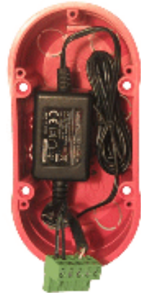
Рис.1. Вариант установки блока питания в монтажную коробку.
