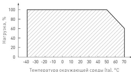
Рис. 2. Максимальная допустимая нагрузка, % от мощности источника.
