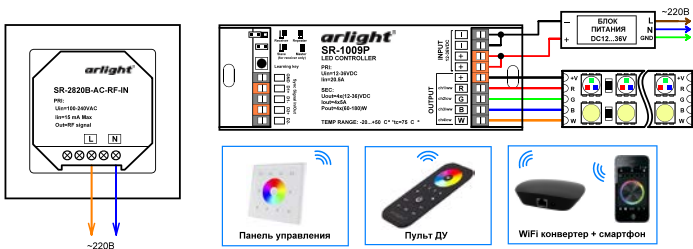
Рис.3. Схема подключения оборудования на примере контроллера SR-1009P
